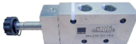
INOX ventil po 720 hodinách v komore so sol'ným rozprašovaním
