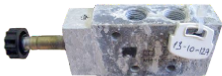
Hliníkový ventil po 720 hodinách v komore so sol'ným rozprašovaním
